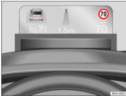
איור 2: בלוח המחוונים מעל ההגה : דוגמאות למידע המוצג בתצוגה העילית
