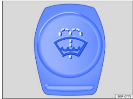
איור 1. בתא המנוע: מכסה מאגר נוזל ניקוי שמשות
