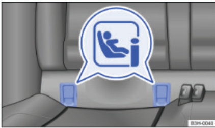
איור 2 סימונים המזהים את נקודות העיגון של מערכת ה-I size למושבי ילדים
