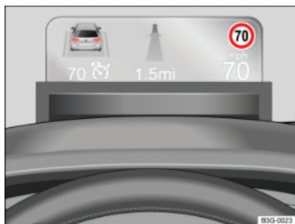
איור 2: בלוח המחוונים מעל ההגה : דוגמאות למידע המוצג בתצוגה העילית
