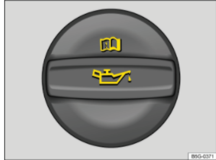
איור 3: בתא המנוע: מכסה פתח מילוי שמן מנוע
